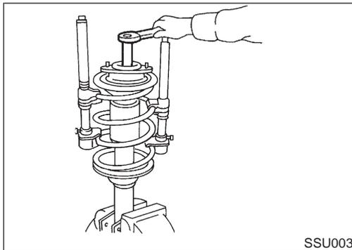
3. Remove piston rod lock nut.
